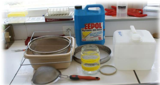
Photo 5 : matériel nécessaire pour le lavage au laboratoire (solution à base de Teepol®).
